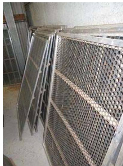
Unterschiedliche Lochgrößen bei den Reinigungssieben für die Saatgutreinigung. Foto: Julia Herrle
