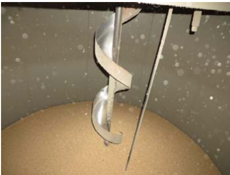
Auf einer Rutschspirale werden die Körner so tief wie möglich zum Siloboden befördert. Foto: Julia Herrle
