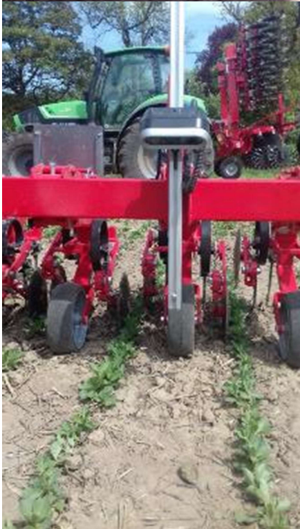
Kamera und Spurkranzräder zur Führung der Hacktechnik, Fotos: Stephan Gehrendes, Bioland
