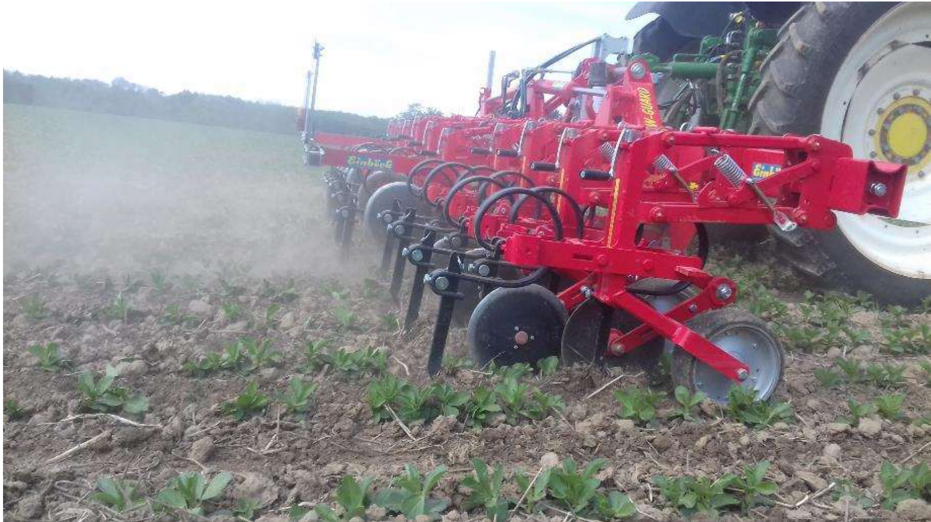
Scharhacke in Heckenbau in jungen Ackerbohnen, Einzelparallelogrammgeführte Hackaggregate, Stephan Gehrendes, Bioland Beratung
