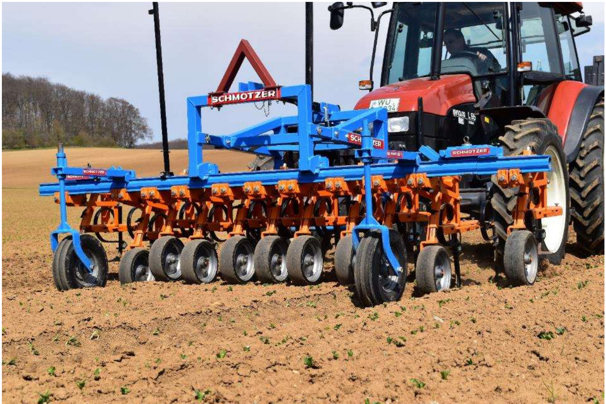
Scharhacke in Frontanbau in jungen Ackerbohnen, Einzelparallelprogrammgeführte Hackaggregate, Alexander Kögel, Bioland Beratung
